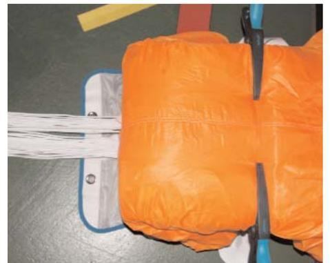
Procédez à la mise en forme des 2 oreilles. Faites 1 à 2 plis par dessous afin de former un bloc rigide et insérez chaque oreille dans le sac de déploiement. Rentrez le reste de la voile et verrouillez les 2 premières loves.
