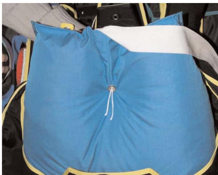
Verrouillez les 2 languettes latérales de la manière suivante: Laissez 30 cm de mou de drisse entre le sac de déploiement et le verrouillage Passez l'élastique au travers le l'oeillet
