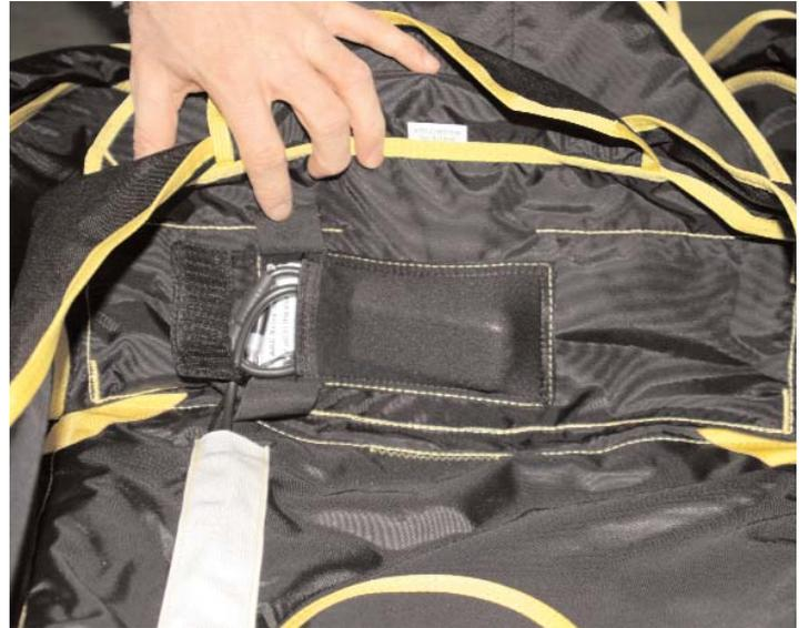
Ressortez le cutter afin de le placer dans son logement et placez le trou de la guillotine bien au dessus de l'oeillet.
