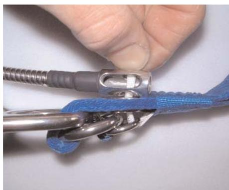
Insérer le câble dans la boucle et rangez le. Le montage doit être comme sur cette photo.
