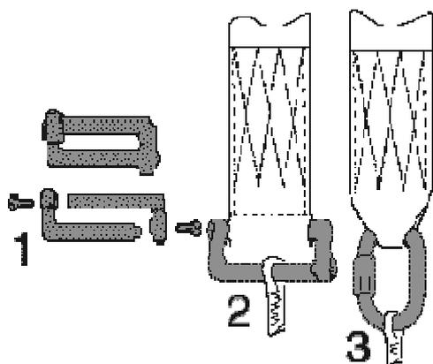
Links de Tirante e Barra Os links de barra (DESENHO 1) devem ser usados apenas em tirantes de reserva que os comportem, se não houver a costura grossa (DESENHO 2) delimitando o espaço para este link, substitua-o por links número 5 ou 6 (DESENHO 3). Se houver necessidade de manter os links de barra, então envie o equipamento para um Master Rigger para que sejam adicionada as costuras para suportar tais links.
